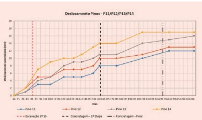
**Figura 6. Deslocamento dos pontos P11 a P14.**
